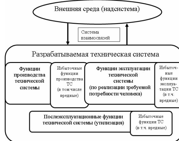
Рис. 9. Функциональный состав разрабатываемой технической системы
